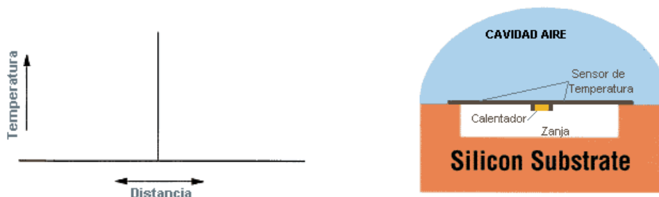
Fig. 15 Componentes del sensor y ejes de referencia de las variables asociadas.
