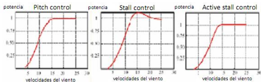
Figura 7: Curvas de potencia para máquinas reguladas por Pitch, Stall y Active Stall Control
